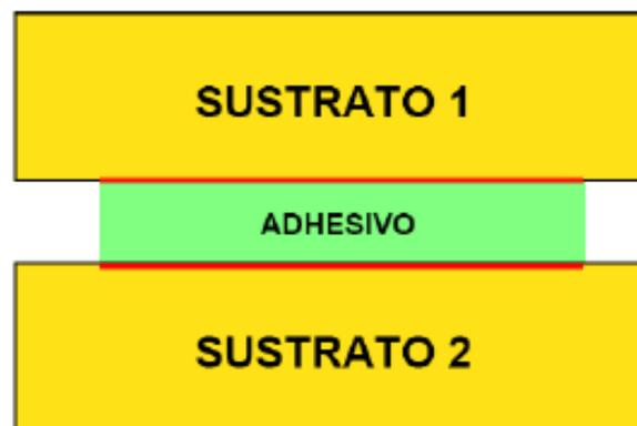
Figura 1. Esquema básico de una unión adhesiva.
